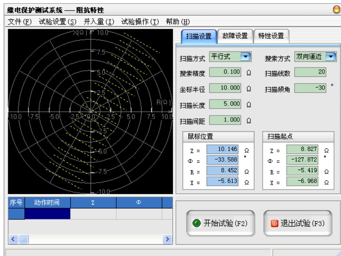
试验中待测试的扫描边界点由起点阻抗Z、扫描线倾角、间距以及扫描线数目决定，同理，此处扫描线倾角以平行于R轴为0°。设置完以上参数后，程序自动以起点阻抗Z为开始，沿R轴正方向，按“扫描间距”等距离地计算各扫
