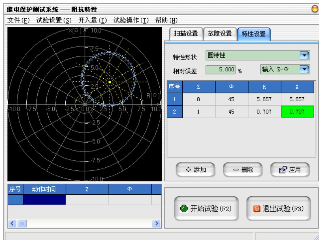
设置完阻抗特性图的参数后，点击“应用”即可绘制出设置的阻抗特性图。
